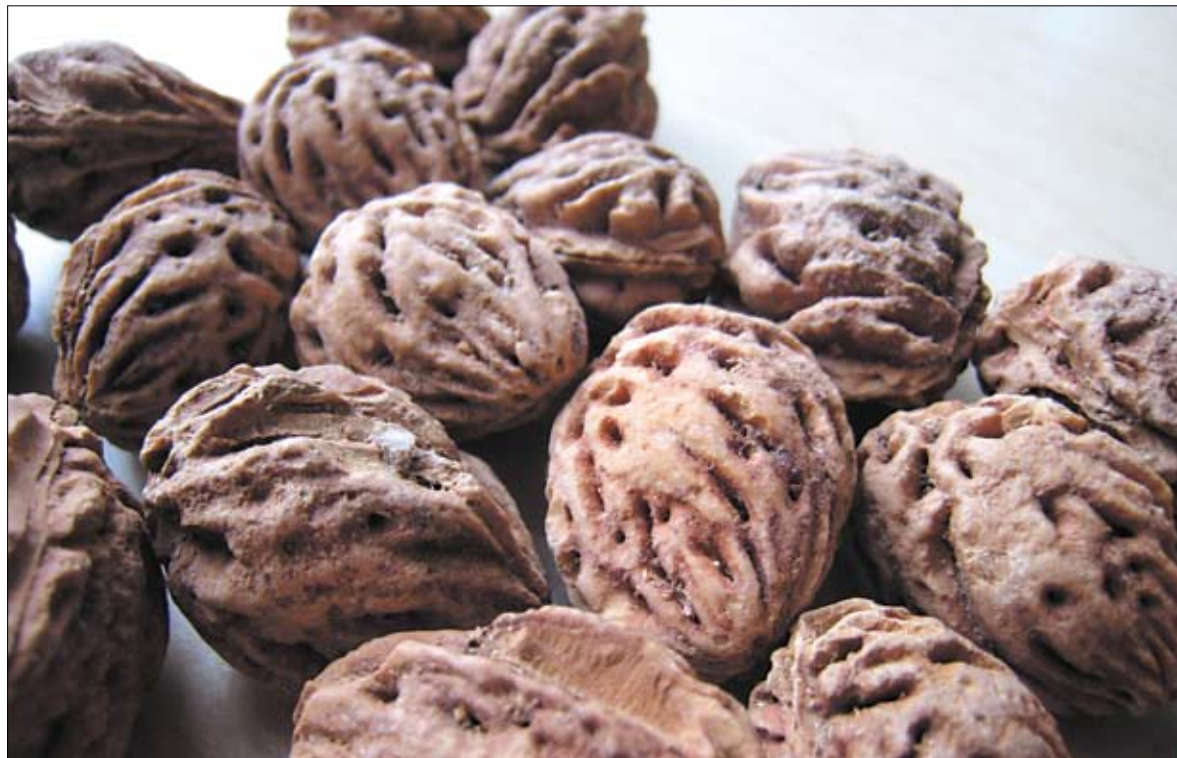
Die Kraft der Pfirsichkerne ist ihre Härte. Ein Granulat daraus eignet sich hervorragend als Schleifmittel für Aluminium oder für die Herstellung von Fußbodenplatten. Foto: Petra Blauensteiner, ÖGUT
