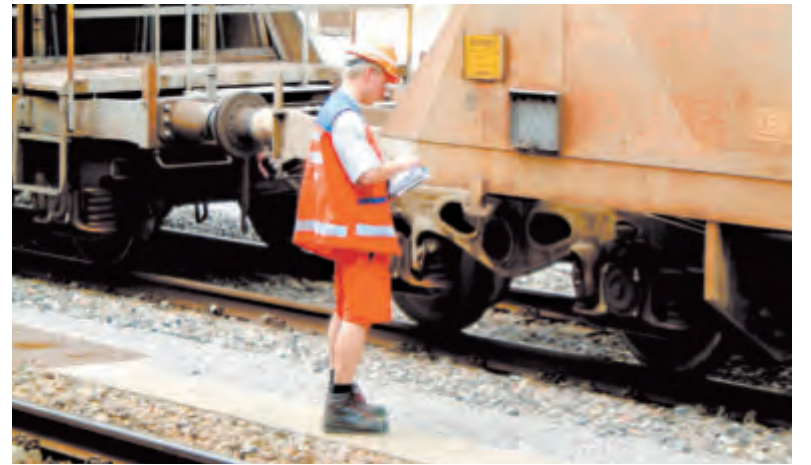
Papier adieu – am Bahngleis können Daten ins Handy eingetippt und via GSM-R-Funk an die Leitstelle gefunkt werden. Foto: APA
